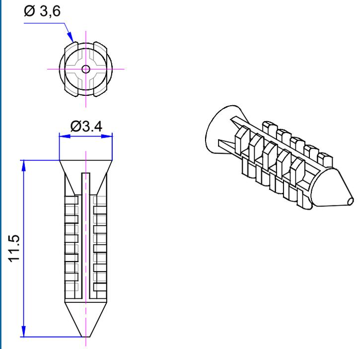
Mit den speziellen Lamellenrieten können handelsübliche Drahtschutzgitter durch die Bohrungen in den Steckfüßen der Lüftermanschetten Typ LM-40-xx bis LM-92-xx befestigt werden.
