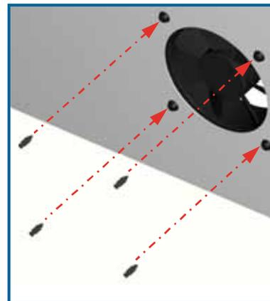
Die speziellen Sicherungsrieten können in die Bohrungen der Steckfüße der Lüftermanschetten vom Typ LM-40-xx bis LM-92-xx gesteckt werden, so dass die so befestigten Lüfter selbst extreme Fall- und Rütteltests überstehen.
