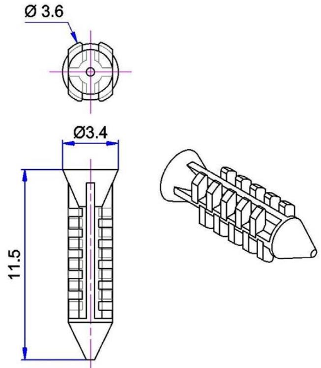
Mit den speziellen Lamellennieten können handelsübliche Drahtschutzgitter durch die Bohrungen in den Steckfüßen der Lüftermanschetten Typ LM-40-xx bis LM-92-xx befestigt werden.
