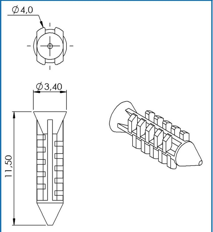
Mit den speziellen Lamellenrieten können handelsübliche Drahtschutzgitter durch die Bohrungen in den Steckfüßen der Lüftermanschetten, Typ LM-40-xx bis LM-92-xx, befestigt werden.
