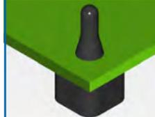
Das Steckelement wird durch eine Bohrung in der zu befestigenden Leiterplatte gezogen.
