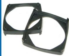
Unsere patentierten Manschetten ermöglichen eine schraubenlose Lüftermontage in wenigen Sekunden. Da sie aus elastischem Material bestehen, verhindern sie die Übertragung von Vibrationen und Schwingungen der Lüfter auf die Gehäusewand und reduzieren dadurch die Geräuschentwicklung um bis zu 9 db (siehe Geräuschmesseprotokoll auf Seite 5).
