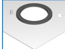
Die einseitig selbstklebenden Dichtringe können zur Abdichtung des Saug- und Druckraums auf die Montageplatte oder den Radiallüfter geklebt werden.
